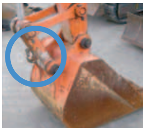
Gancio sulla biella di manovra
